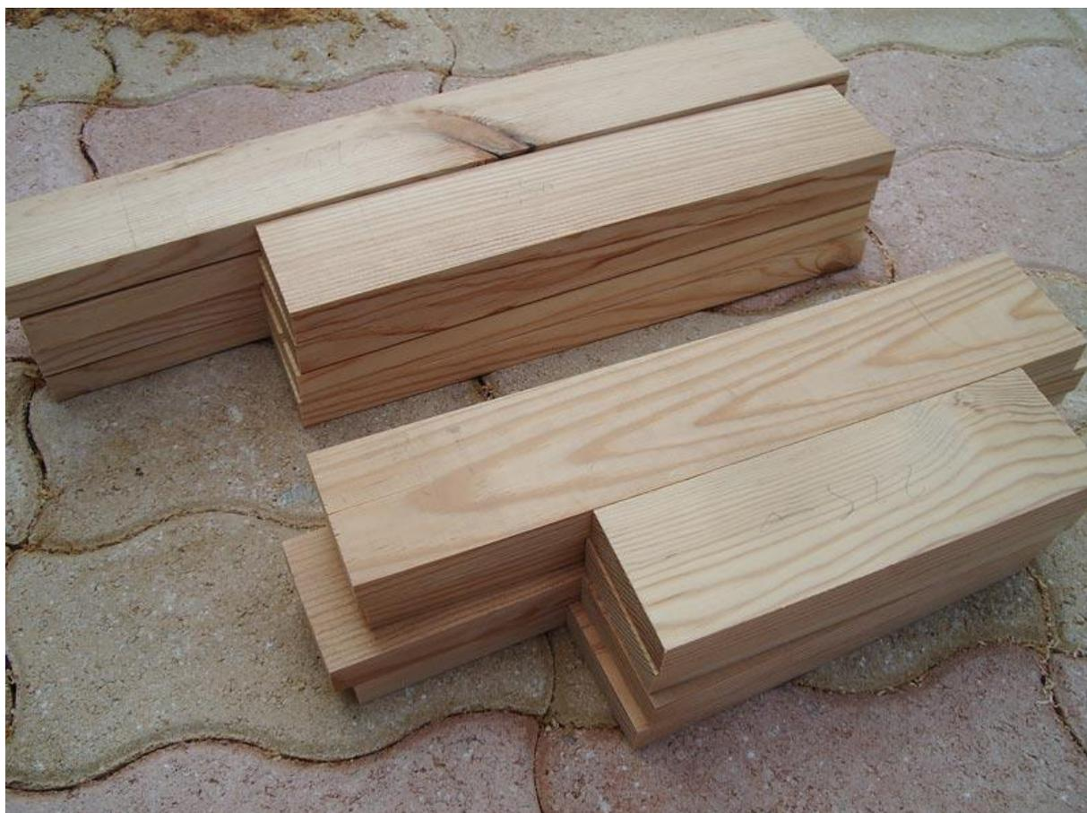
On obtient quatre longueurs différentes, deux pour les morceaux verticaux et deux pour les horizontaux.
