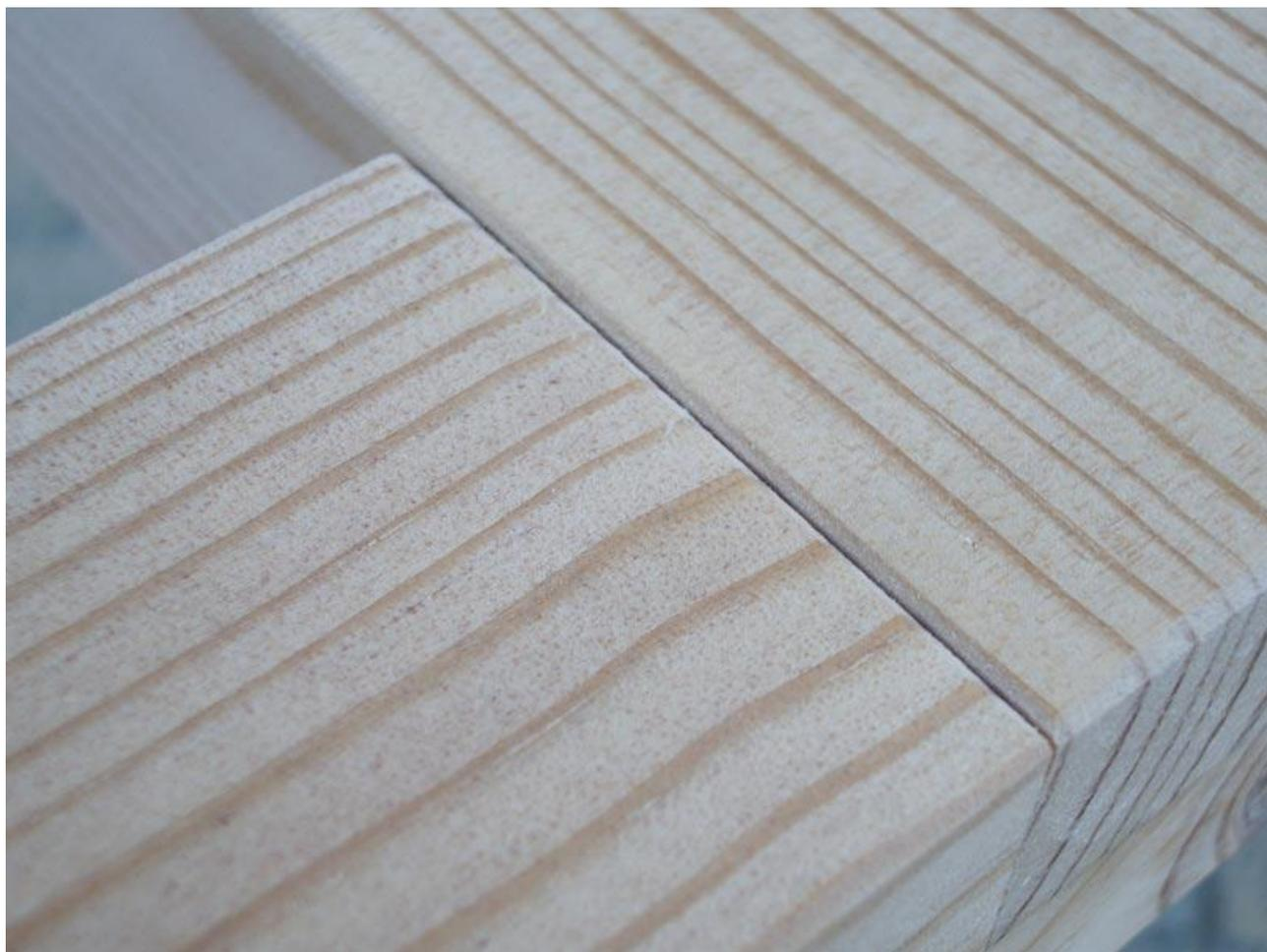
Puis on colle les pièces en vérifiant l'équerrage. La technique est de mesurer les diagonales du quadrilatère obtenu : si elles sont identiques (à +/- 1 mm), cela veut dire qu'on a un bon rectangle et on laisse la colle prendre ; sinon, on joue du maillet pour y arriver avant que la colle tire.
